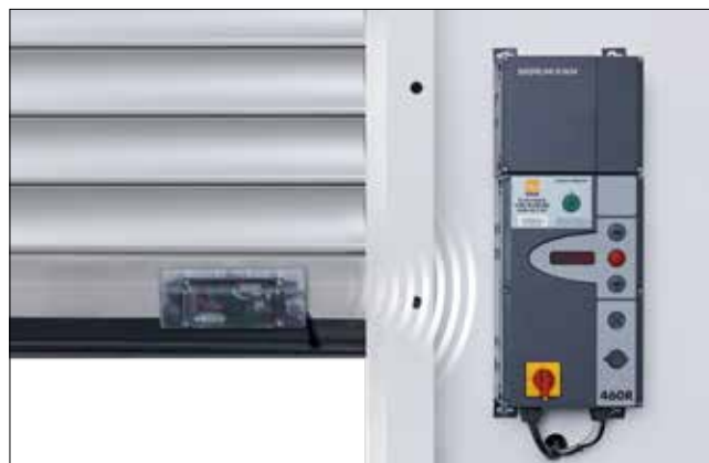
Optional: Funkübertragungseinheit zur Übertragung der Signale vom Torbehang via Bluetooth zur Steuerung – an Stelle einer Wendelleitung. Die Stromversorgung erfolgt über eine leistungsstarke Batterie. Für die Steuerungen: 445 R / 460 R
